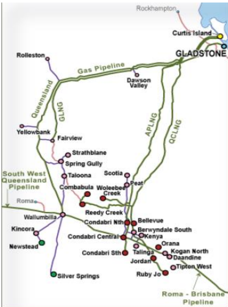
Figure 3-9 LNG Pipelines Map
